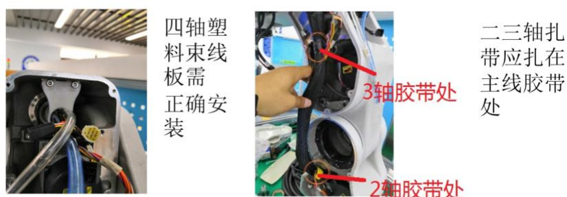
图 15 束线板安装与扎带位置
