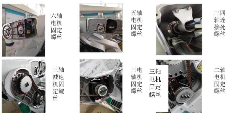
图 16 安装垫片的螺丝及其位置
