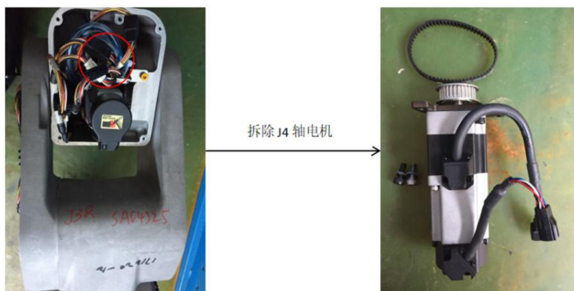
图 9 拆卸 J4 轴电机示意图
