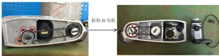
图 12 J5 轴拆卸示意图
